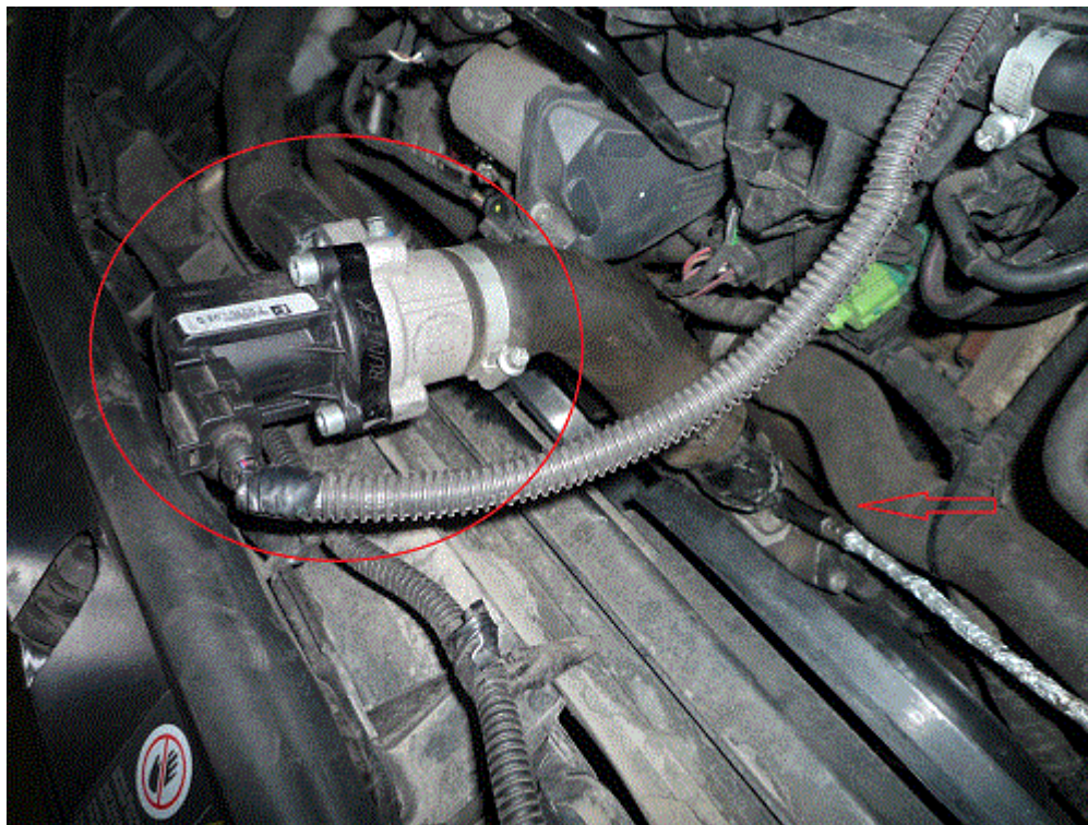
Фото 5 - разгрузочный клапан. Стрелкой показана форсунка для впрыска метанола
