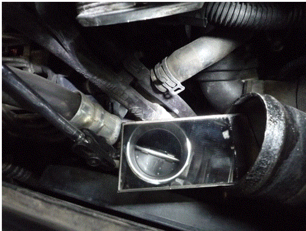
Фото 3 - половинка дроссельной заслонки отсутствует
