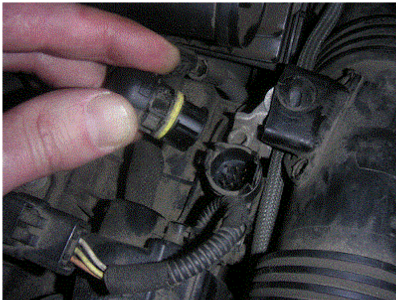
Фото 5 - отключение датчика эксцентрикового вала
