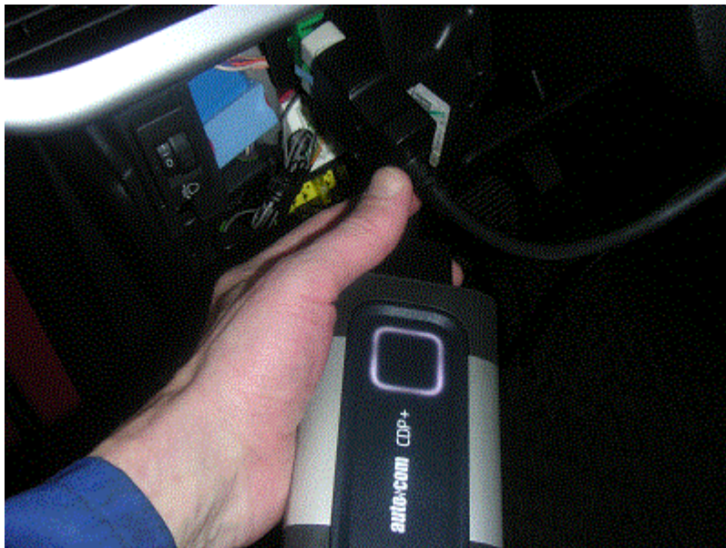
Фото 2 - подключение интерфейсного модуля сканера
