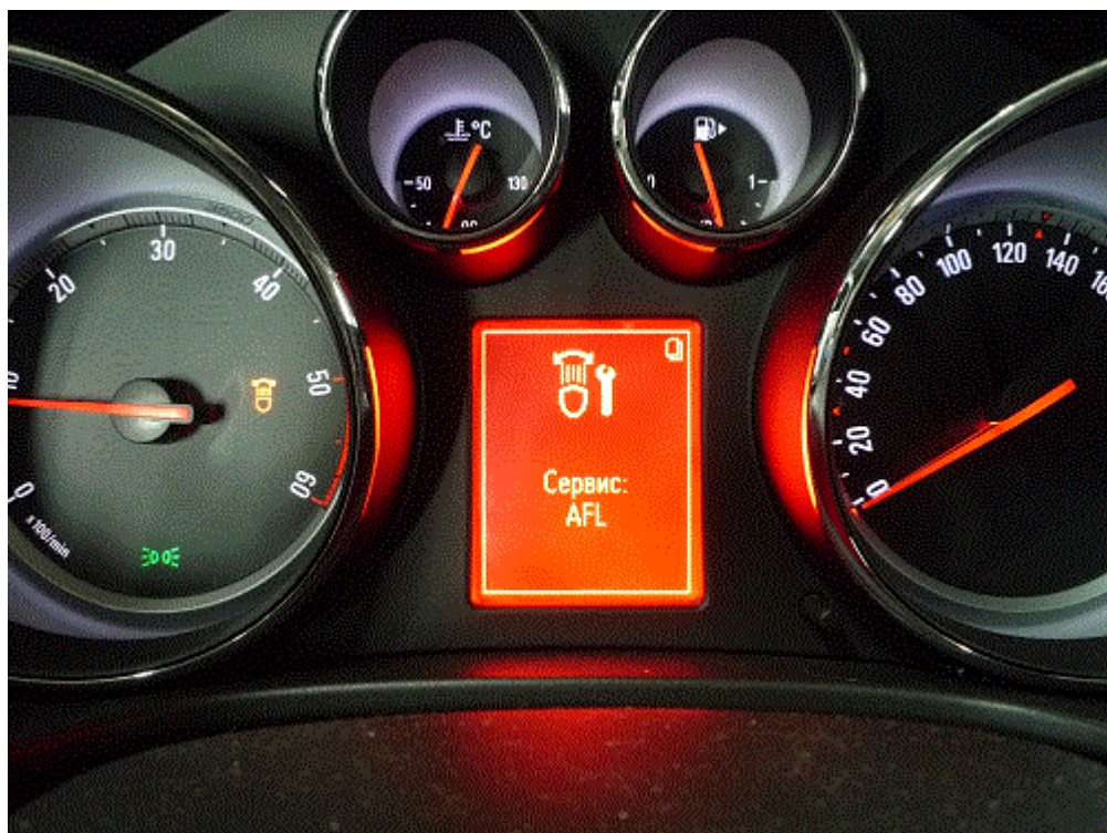
Фото 2 - система AFL неисправна
