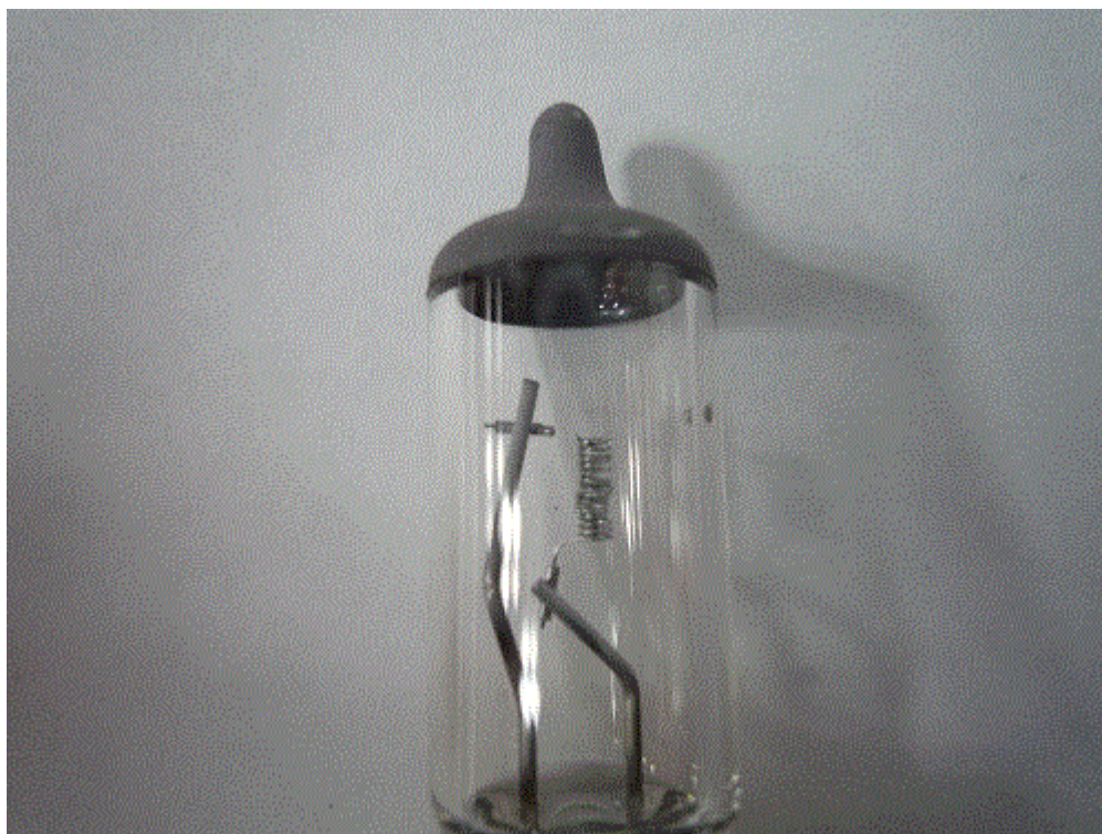
Фото 4 - и конечно видим перегоревшую лампу
